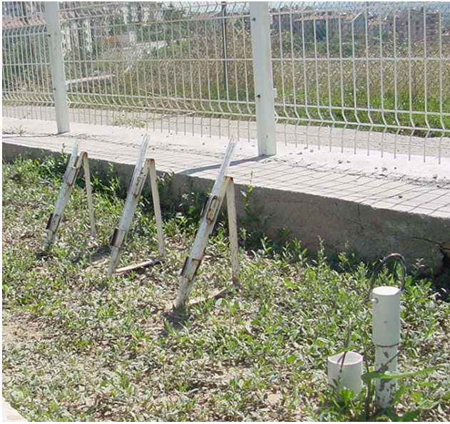
Şekil 3.4. Toprak sıcaklığı rasatları
