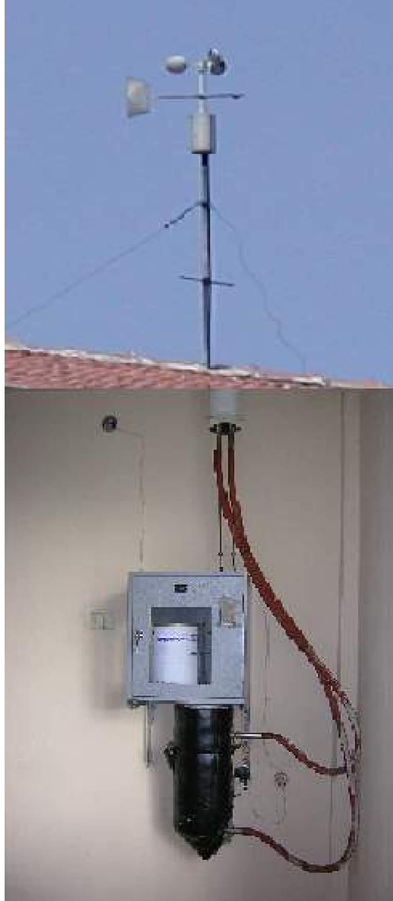
Şekil. 5.4. R. Fuess tipi anemograf kaydedici sistemi
