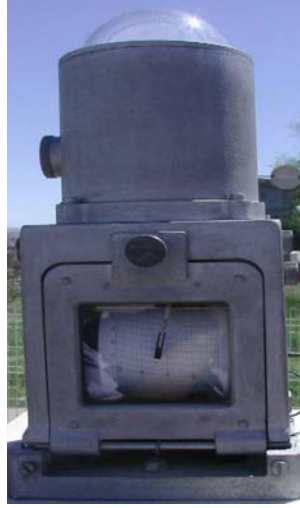
Şekil 6.7. Robitzsch tipi bimetallik Aktinograf
