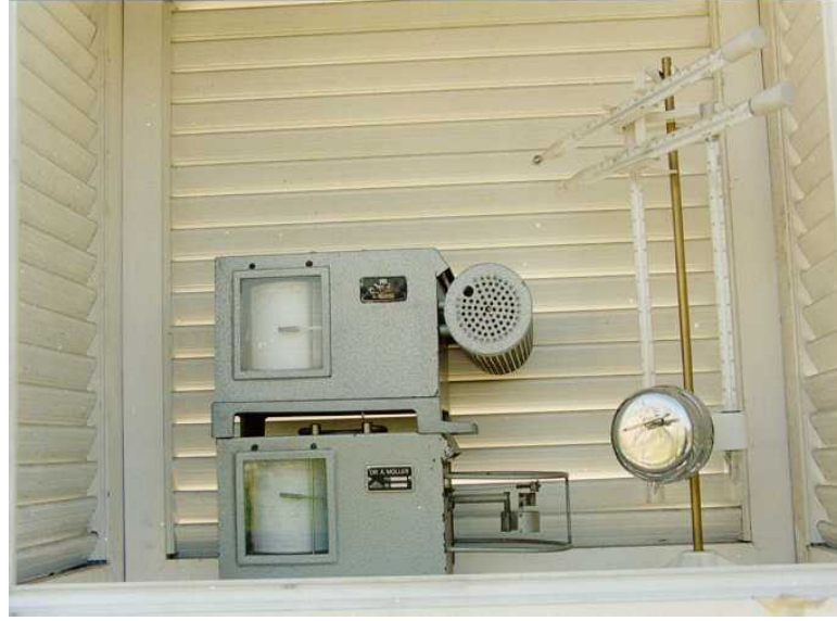
Şekil 3.12. Sıcaklık siperlerindeki aletlerin konumu
